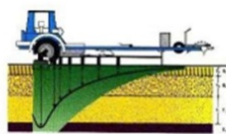
Figura 2. Representação esquemática dos deslocamentos verticais do pavimento auscultado
